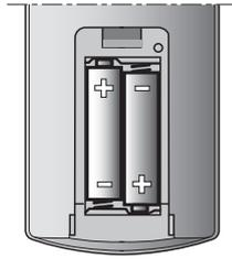
**!** Leere, verbrauchte Batterien können auslaufen und die Fernbedienung beschädigen! Entfernen Sie die Batterien, wenn die Fernbedienung über einen längeren Zeitraum nicht benutzt wird.
