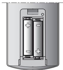
**!** Le liquide contenu dans les batteries usagées et vides peut s'écouler et endommager la télécommande ! Enlever les batteries de leur logement lorsque la télécommande n'est pas utilisée pendant une longue période.
