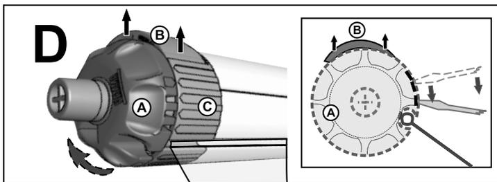
**DE** Funktionszweck. Durch das Drehen der Spannschraube (A) im Uhrzeigersinn, dehnt sich der Flansch (B) zunehmend aus: kann durch die Einkerbungen an der Abdeckung (C) reguliert werden.
