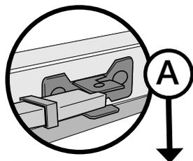
**DE** **Achtung Sicherheit.** Das Endstück des Stützfußes (A) wurde so entwickelt, dass ein falsches Positionieren in der Frontblende (wodurch sich die Frontblende nicht korrekt schließen würde) während der Markisenschließung verhindert wird; es wird daher empfohlen, dieses auf die richtige Art und Weise, mit der Basis zur Front hin, zu positionieren.
