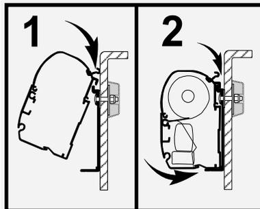
**DE** Die Halterungen sind bereits mit 2 Bohrungen versehen: für die Anbringung der Markise ist jedoch nur eine Schraube (in der Ausstattung enthalten) notwendig, verwenden Sie die einfachere Bohrung.
