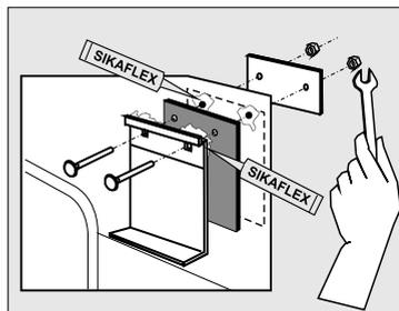
**DE** Es ist immer ratsam, die 3 Halteplatten vom Montagesatz bei der Installation der Markise zu verwenden. Für eine sichere Befestigung der längeren Markisen (ab 400) sind jene jedoch unentbehrlich.
