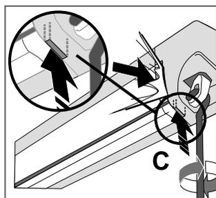
**DE** Bei komplett eingefahrener Markise ist die rote Anzeige nicht mehr sichtbar. Die Markise ist jetzt verriegelt. Die Verriegelung erfolgt ohne spürbaren Widerstand.
