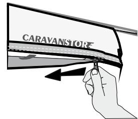
**DE** Anbringung des Zubehörs zur Spannung der Markise.
