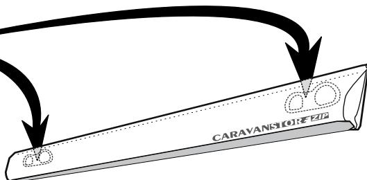
**DE** Die Markise enthält serienmäßig 2 Stossdämpfer, welche in Position der Rafter, bei Anbringung der Rafter Caravanstore oder Caravanstore Support Leg, angebracht werden. Es wird empfohlen, die im Lieferumfang enthaltenen Stossdämpfer (**B**) hinten am Markisensack anzubringen.
